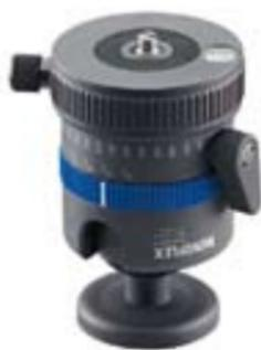
Die Kugelneiger der Classic Ball Serie von NOVOFLEX können auch um 180° gedreht verwendet werden kann. Somit kann über die Kugel eine exakte, horizontale Nivellierung, mit Hilfe der im Boden integrierten Libelle, erfolgen. Der ideale Einstieg in die Panorama-fotografie.
